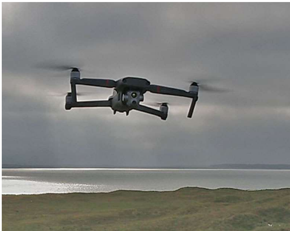
Figur 1. Der blev benyttet en drone af typen DJI Mavic 2 Pro Advanced udstyret med et kamera med 48 MB pixels.
