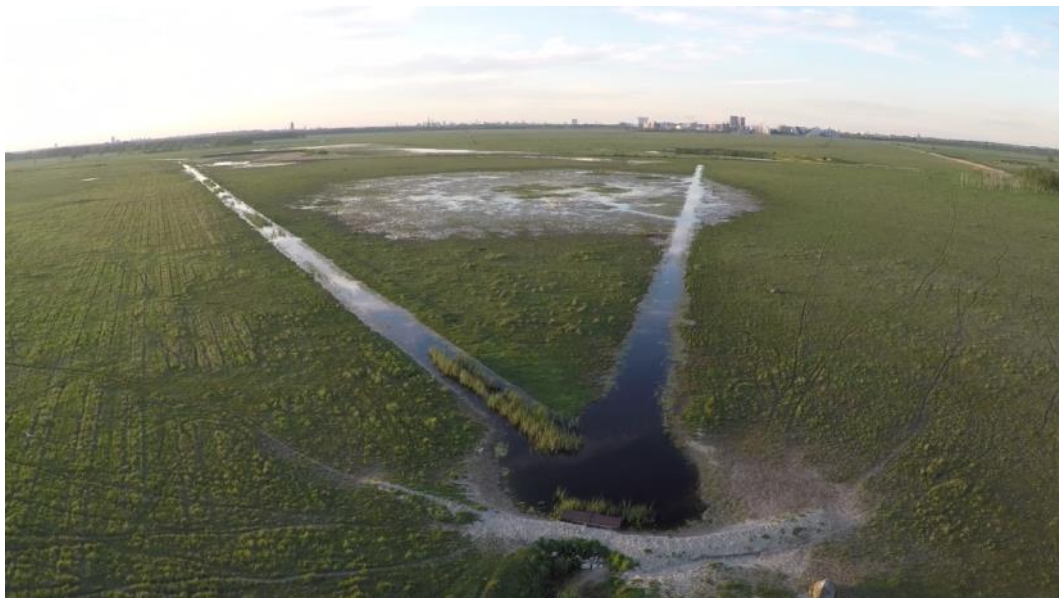
Figur 68. Her ses samme stignord fra luften. Kanten omkring stignordet er forstærket så det kan tåle sliddet fra de græssende kreaturers passage, og så det forhindrer omløb fra vandet.
